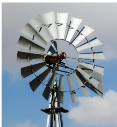
1.8 Сурет - Көп қалақты жел турбинының сыртқы көрінісі
